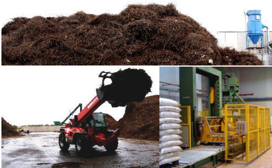
Figura 14. (Arriba) Almacenamiento de podas (Abajo izquierda) Transporte a la planta (Abajo derecha) Instalación de ensacado en bolsas de 15 kg.
