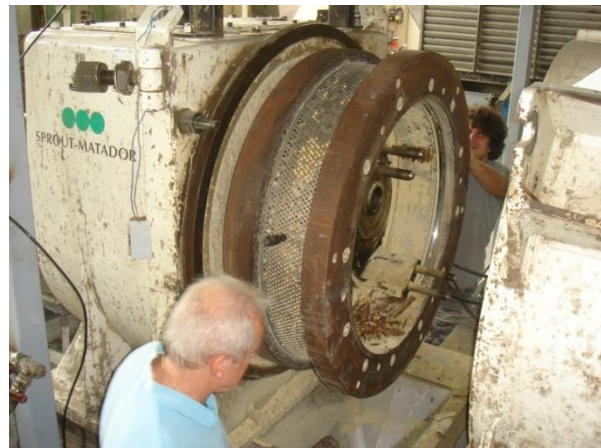
Figure 3: Filière et granulateur de Tschiggerl Agrar (Autriche)
