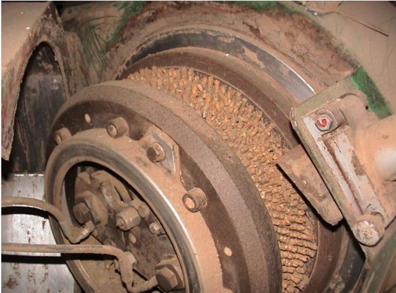
Das Ziel der Pelletierung/ Ballierung besteht in der Erhöhung der Dichte um Transportkosten zu reduzieren und die Handhabung zu vereinfachen...
